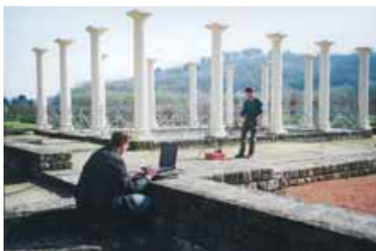
Georadarmessungen liefern Horizontalschnitte aus verschiedenen Tiefen. Diese werden sofort am Computer ausgewertet und können in einer Visualisierung als Schnitte oder auch räumlich dargestellt werden.
